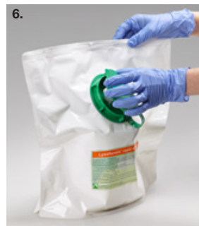
6. Appliquer le bouchon en plastique sur l'ouverture du dispositif de prélèvement et visser sur le contre-écrou.
